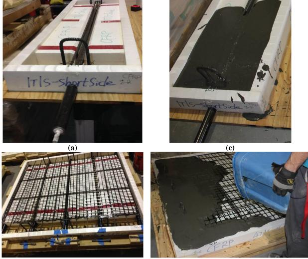
**(b) (d)** Figure 4.15 Specimen Preparation: (a) & (b) Formwork, and (c) & (d) Casting
